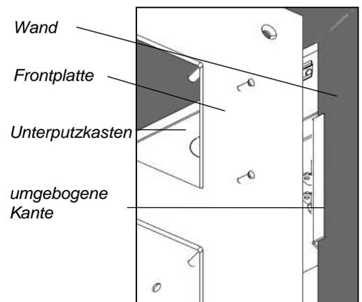
Abb. 11: Ausrichten am Putz
