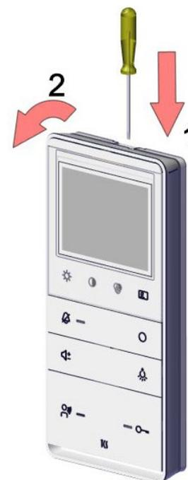
Abb. 6: Gerät aufrasten /entfernen
