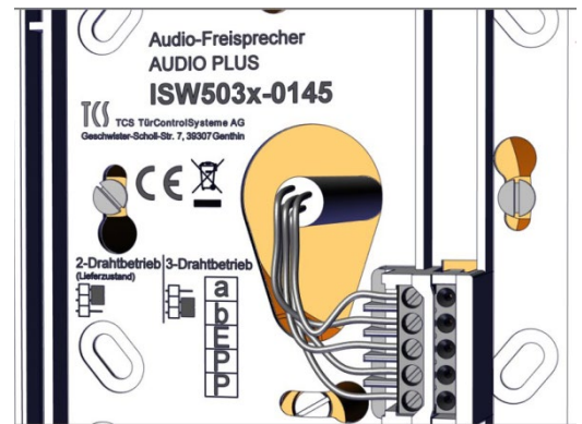
Abb. 9: Leitungen anschließen ISW5030 und ISW5031
