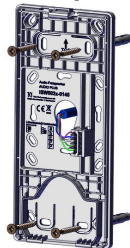
Abb. 5: Montage mittels Schrauben und Dübel
