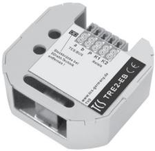
Das Einbau-Ruf-Relais ist ein Ruf-Relais für die Ansteuerung von Zusatzklingeln und Signalgeräten. Es dient zur Auswertung von Sondertastenfunktionen der Innenstationen sowie zum gezielten Türöffnen.
